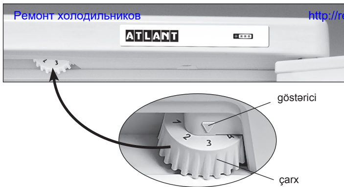
Şəkil 3 — Temperaturun tənzimlənməsi
